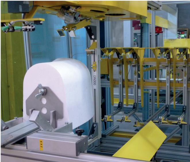
Отличительной особенностью технологии Perfect является горячепроволочная система с компьютерным управлением для высокоточного раскроя негативов водовода и формообразующих вкладышей соединительных патрубков
