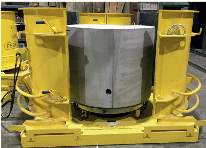
Как правило, распалубка монолитных колец с дном, изготовленных из высокоподвижной смеси, на заводе Fortier 2000 Ltee осуществляется уже на следующие сутки
