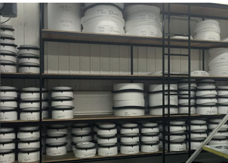
Пенополистироловые вкладыши соединительных патрубков с интегрированными уплотнителями, раскроянные по индивидуальным чертежам с помощью профильного горячепроволочного резака
