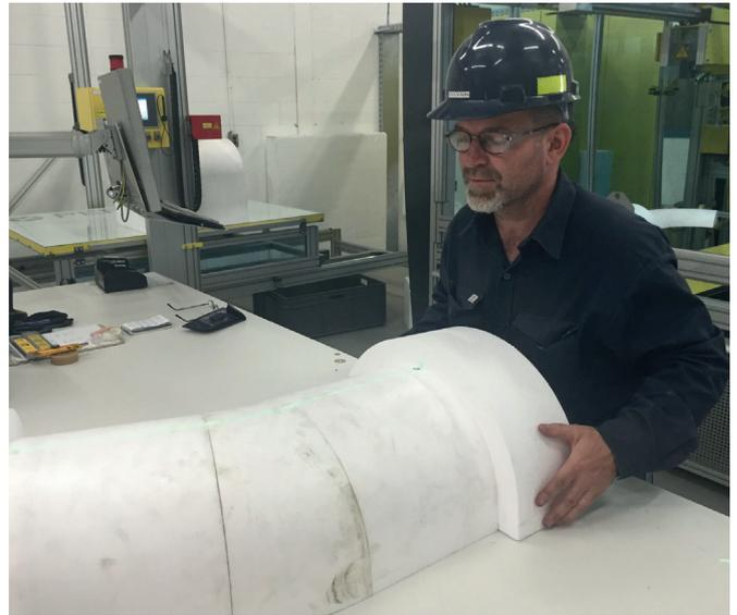
Позиционирующие лазеры помогают рабочему состыковать компоненты негатива водовода и одновременно провести контроль качества
