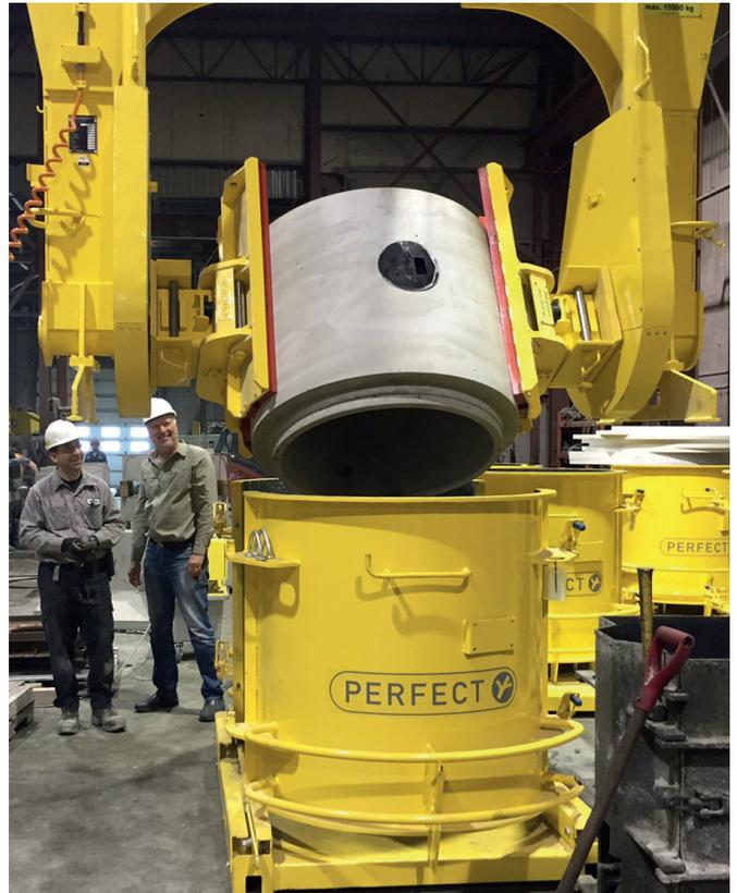
Готовые кольца с дном извлекаются из формы и поворачиваются на 180° при помощи захвата
